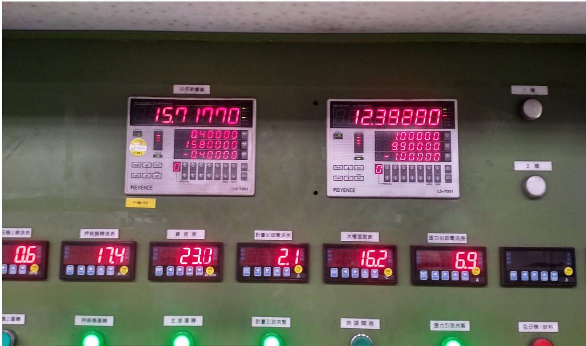
圖 2-4 二台雷射光幕外徑儀架設完成
